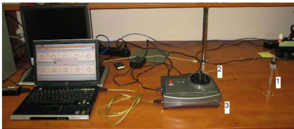
Рис.1. Экспериментальная установка. 1 – пробирка с водой, 2 – титановый цилиндр, 3 – ГРВ камера.
